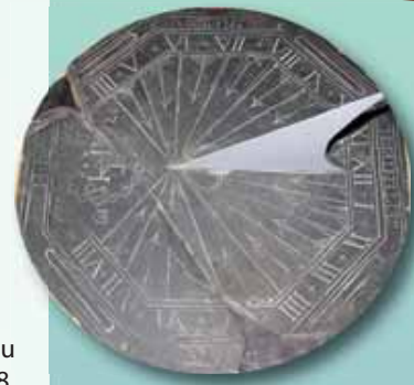
Cadran solaire horizontal de Nicolas du Pineau, manoir de Montergon à Brain-sur-Longuenée (1719) (style à 47,35°, latitude locale; heure solaire = 10 h 30).
